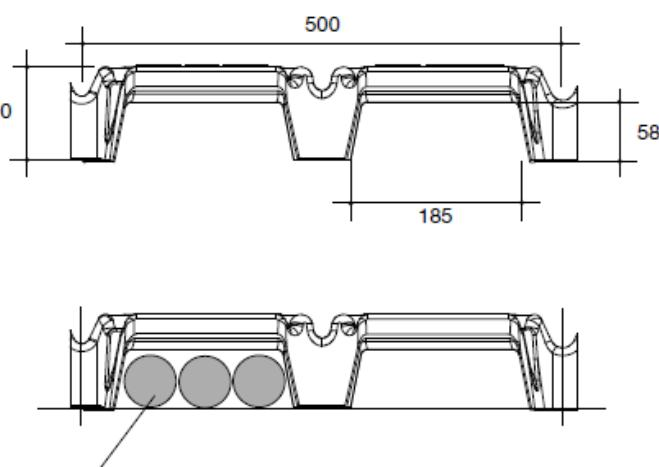
Pod průhyb je možné vložit 3 trubky o průměru 57 mm
