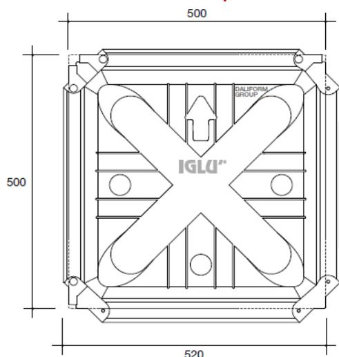
Rozměry jsou uváděny v mm s tolerancí +/- 1,5%.
