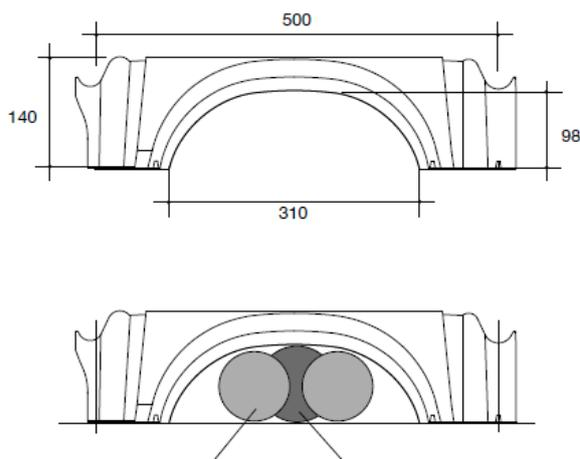
Pod průhyb je možné vložit 2 trubky o průměru 94 mm nebo 1 trubku u průměru 98 mm.
