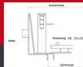
Deckel für Auspflasterung mit Außenpflaster (ohne Dichtung).
